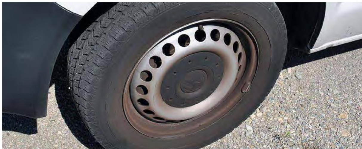
Disk pak i ndryshkur, por pa dëmtime
