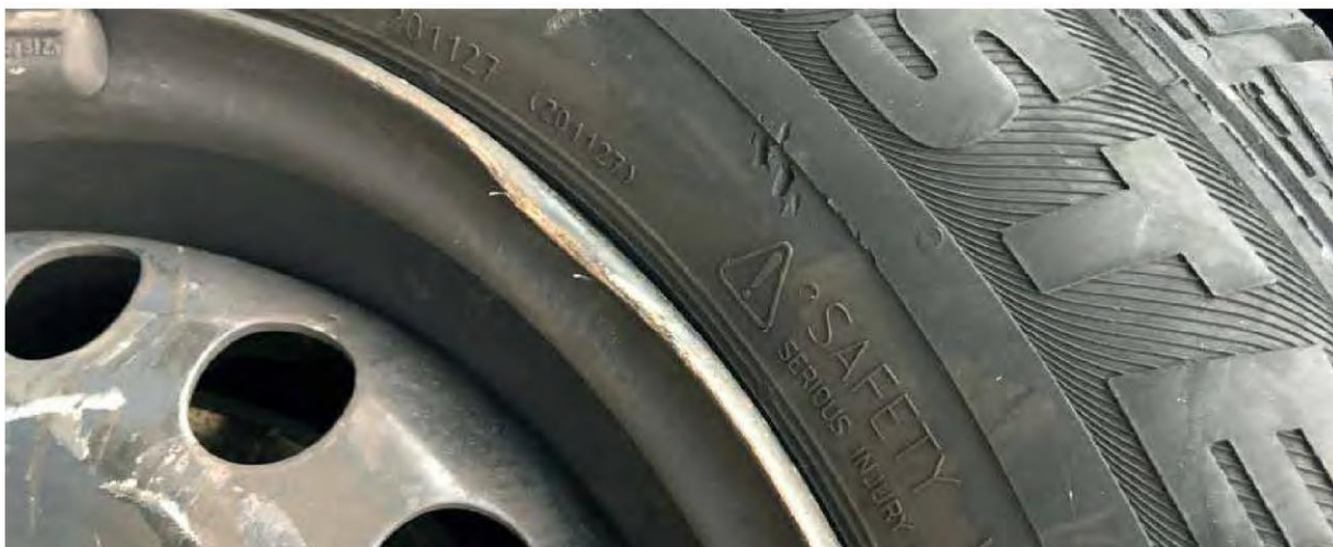
Disk çeliku i deformuar
